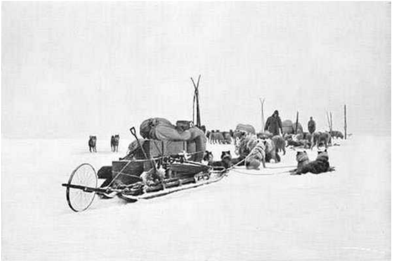
Aquí puede verse un trineo con la rueda del contador de distancia
